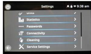
13. Selezionare le statistiche del forno e fare riferimento alla scheda di controllo degli interventi di assistenza per le sostituzioni raccomandate e consigliare il cliente sulle azioni necessarie.
