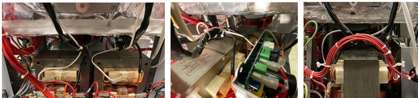
Il forno conneX 16 è dotato di due trasformatori ad alta tensione, uno accanto all'altro, nella parte posteriore del forno, sotto il vano.
