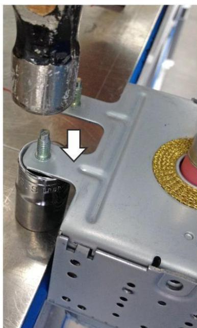
1. I nuovi magnetron sono dotati di quattro prigionieri pressati per il fissaggio. Questi prigionieri devono essere rimossi prima di montare il magnetron sul forno.
