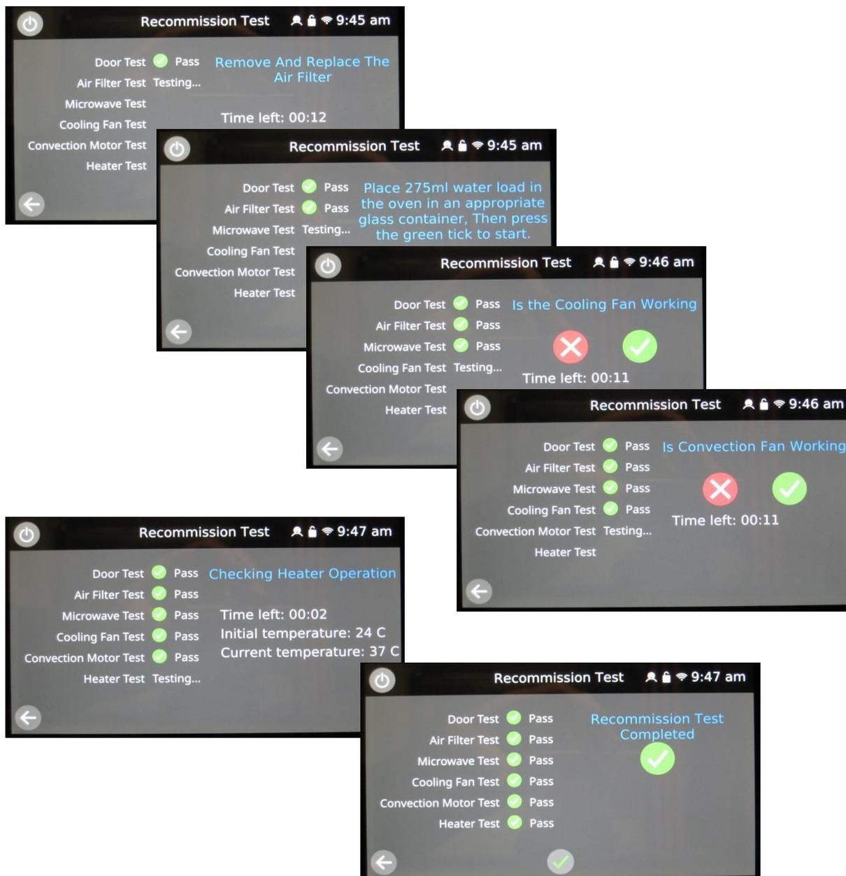
Nota: se si apre lo sportello durante il test dei circuiti a microonde, il processo si arresta e viene registrato un errore.
