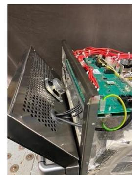
3. Scollegare i collegamenti elettrici: connettori X523 sulla scheda IO, USB, ethernet e cablaggio dell'altoparlante.
