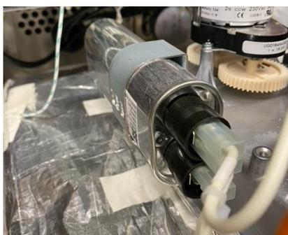
Il condensatore ad alta tensione si trova sulla parte superiore del vano ed è fissato mediante una staffa in lamiera e una vite Pozidriv (PZ2).
