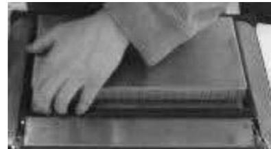
**6.** Premere con decisione verso il basso per fissare saldamente la guarnizione sullo sportello. Accertarsi che sia a livello ed ad angolo retto. Rimuovere l'eccesso di sigillante che sporge dalla guarnizione dello sportello.
