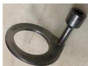
6. L'agitatore è posizionato all'interno della parte superiore del vano del forno, sopra la piastra divisoria.
