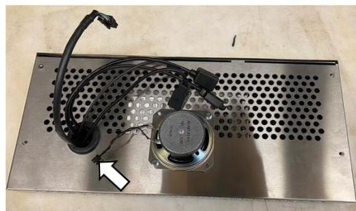
4. Svitare le tre viti Pozidriv sul fondo del pannello anteriore rimosso e sfilare dalla parte superiore del pannello per la separazione dalla parte metallica.
