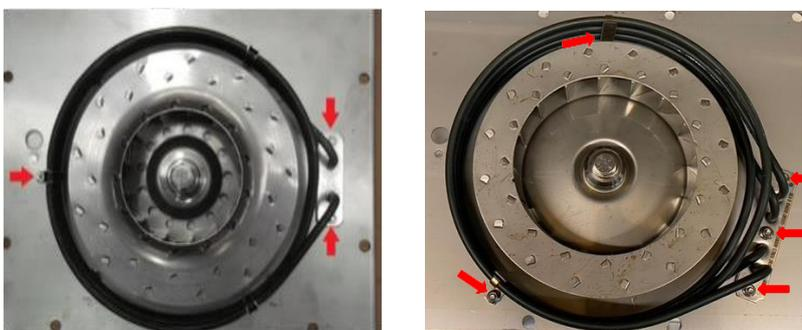
L'elemento è fissato mediante due bulloni esagonali M7 sul forno conneX 12 e tre bulloni sul forno conneX 16, serrati a una coppia di 2,1 Nm e supportati da un singolo dado flangiato esagonale M5.5 sul forno conneX 12 e due dadi sul forno conneX®16, serrati a una coppia di 1,7 Nm.
