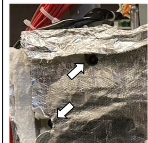
1. Rimuovere il nastro attorno al bordo posteriore del vano.
