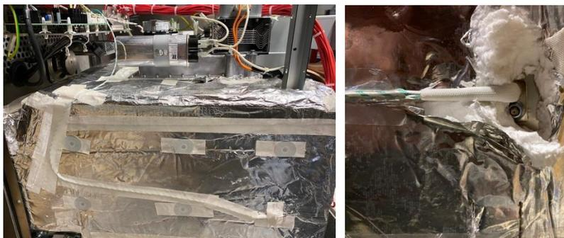
La misurazione della temperatura del vano viene eseguita da un sensore di temperatura (termocoppia) collegato alla scheda IO.
