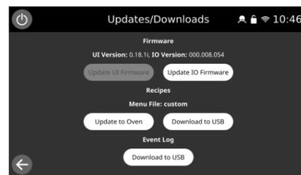
**5.** A causa delle dimensioni del firmware UI, attendere 90 secondi per la lettura della chiavetta USB. Se la scheda "Aggiorna firmware UI" rimane disattivata, non è disponibile alcun firmware compatibile sulla chiavetta USB.
