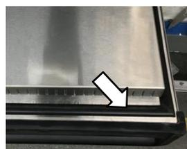
**6.** Controllare la guarnizione dello sportello, verificando che sia integra, senza allentamenti o sezioni rotte o incurvate. Sostituirla se necessario e lasciare asciugare il silicone.
