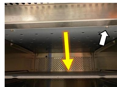
**7.** Smontare e rimontare la piastra a impatto superiore, verificandone la pulizia e controllando l'eventuale presenza di segni di danni (se necessario, seguire le istruzioni riportate nel kit della piastra a impatto sostitutiva). Controllare visivamente la piastra divisoria per l'eventuale presenza di segni di scolorimento o danni.
