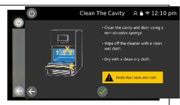
**8.** Pulire il vano con una spugna non abrasiva. Rimuovere il detergente con un panno bagnato, assicurandosi di eliminare ogni traccia di prodotti chimici e residui. Se necessario, è possibile pulire delicatamente anche la parte superiore del vano e la guarnizione dello sportello per rimuovere eventuali residui di cibo. Asciugare con un panno pulito e asciutto.
