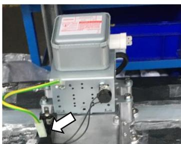
Un diodo ad alta tensione (variante e2s a 1000 W)
