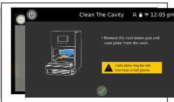
**4.** Una volta completato il processo di raffreddamento, rimuovere la piastra di cottura e il recipiente con l'acqua se utilizzato. Seguire quindi le istruzioni visualizzate sullo schermo: ora il forno è pronto per essere pulito.
