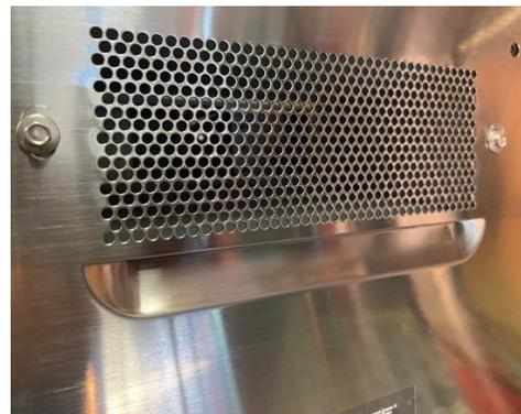
L'aria proveniente dalla ventola di raffreddamento viene forzata attraverso le alette di raffreddamento del magnetron e nel condotto di raffreddamento, che a sua volta scarica l'aria riscaldata dalla parte posteriore del forno.
