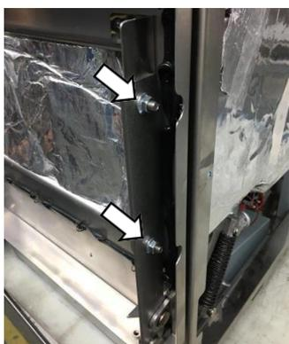
**4.** Svitare e rimuovere i quattro dadi di bloccaggio flangiati M5 e i bulloni a testa esagonale M5 dalle cerniere dello sportello.
