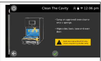
**6.** Spruzzare il detergente approvato da Merrychef® su una spugna e passarla all'interno del forno sui lati, sulla parte posteriore, sulla base e sullo sportello del forno. Evitare la superficie superiore e la guarnizione dello sportello.
