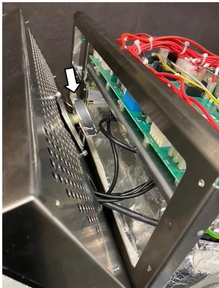
L'altoparlante è situato sulla parte posteriore del pannello anteriore, dietro la UI, fissato mediante due dadi esagonali M7 e collegato direttamente al cablaggio della UI.
