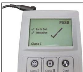
1. Collegare il cavo di alimentazione del forno a un tester portatile per apparecchi.
